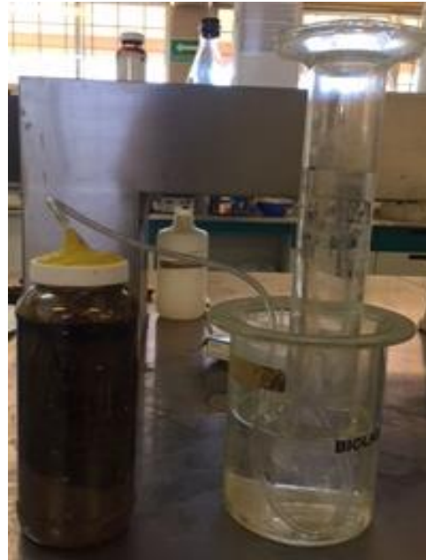
Figura 1. Sistema de digestión escala laboratorio.
